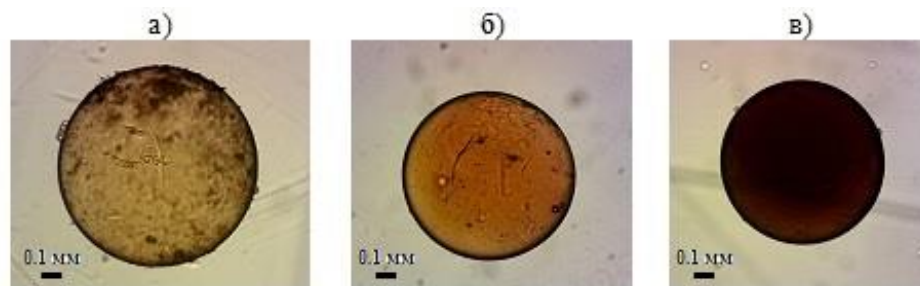
Рисунок 16 – Фотоизображения гранул, полученные при импрегнировании ПВС солями железа (III) и (II) с концентрациями: а) 0.02 и 0.01 моль/дм 3 соответственно, б) 0.05 и 0.025 моль/дм 3 соответственно, в) 0.10 и 0.05 моль/дм 3 соответственно
