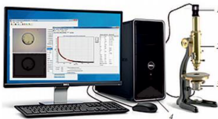
Рисунок 8 – Прибор для изучения набухания гелей гидрофильных полимеров методом оптической микрометрии [198]
