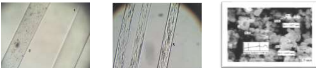
Микрофотографии свежесформованной полипропиленовой нити: 1 – без добавок; 2 – с добавкой 2% УДПТФЭ; 3 – с добавкой 2% УДПТФЭ после ориентационного вытягивания
