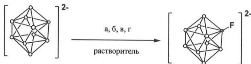
Рисунок 3. Схема получения монофторпроизводных клозо-декаборатного аниона. Условия: а = TBAF, CF_3COOH ; б = NH_4HF_2 ; в = KF, 18-краун-6, CF_3COOH ; г = Me_4NF , CF_3COOH ; растворитель = THF, DME, DCM или CH_3CN ; t = от 25^\circ C до температуры кипения растворителя.
