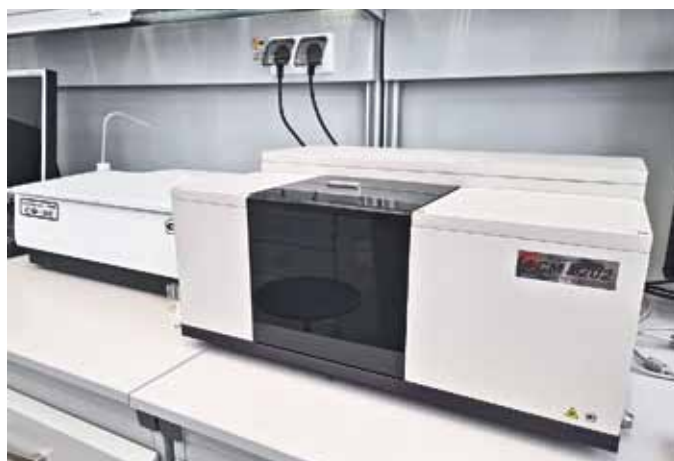
ИК-фурье-спектрометр «ИНФРАСПЕК ФСМ 2202» необходим для анализа гибридных органо-неорганических наноматериалов, координационных соединений, биополимеров
