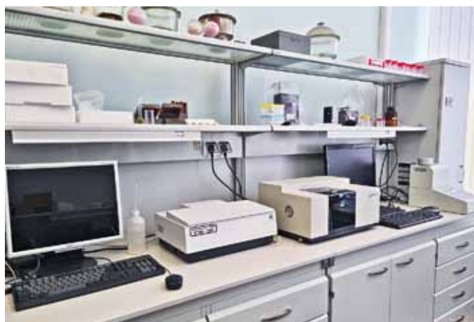
ИК-фурье-спектрометр «ИНФРАСПЕК ФСМ 2202» необходим для анализа гибридных органо-неорганических наноматериалов, координационных соединений, биополимеров
