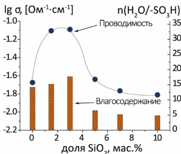
Рисунок 32 - Зависимости логарифма протонной проводимости (при 30°C, в контакте с водой) и влагосодержания (при RH=95%) мембран МФ-4СК от содержания оксида кремния. Мембраны получены отливкой из раствора полимера в присутствии прекурсора
