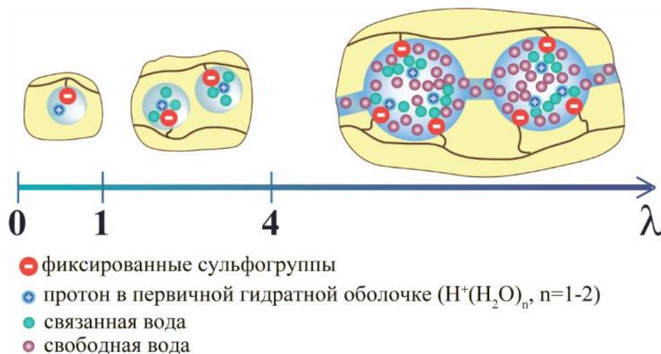
Рисунок 3 - Схема состояния молекул воды в ПФСП мембране при различном влагосодержании,  $\lambda$  – количество молекул воды, приходящихся на одну сульфогруппу
