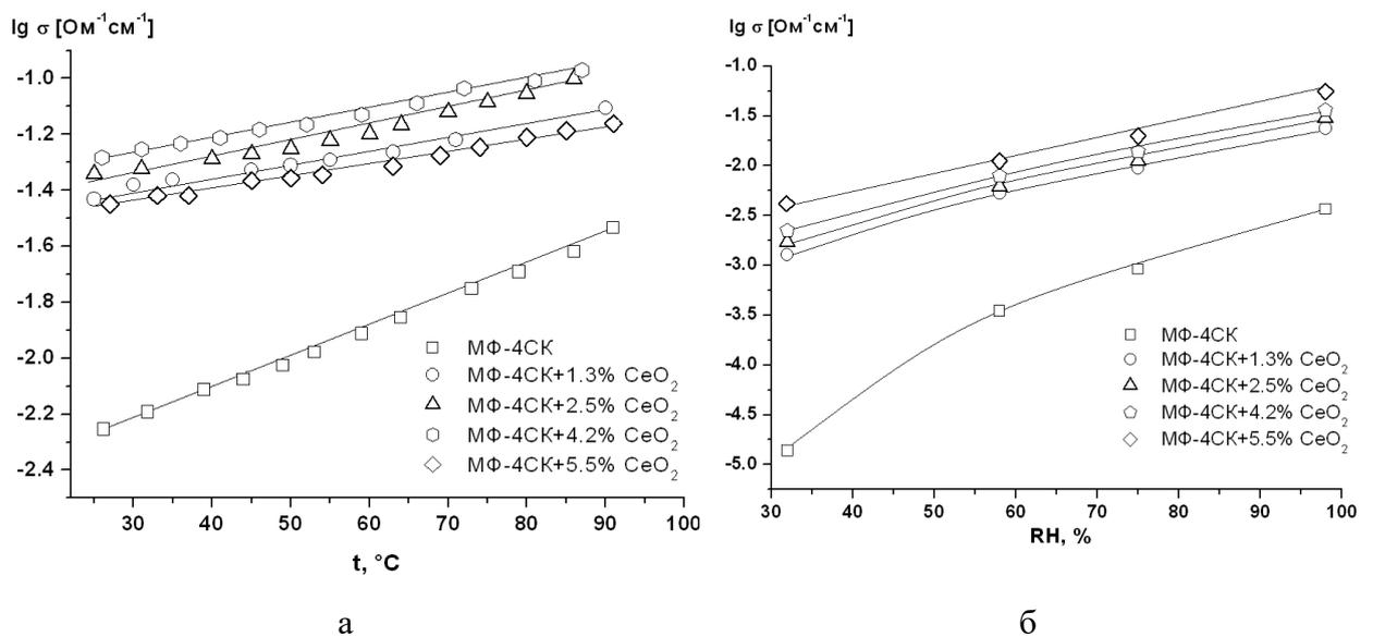
Рисунок 43 - Зависимости протонной проводимости от температуры в контакте с водой (а) и от относительной влажности при 25°C (б) для мембран МФ-4СК+ $\text{CeO}_2$ , полученных методом отливки. Указаны значения содержания допанта в мас.%
