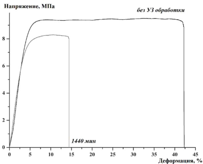
Рисунок 24 - Кривые напряжение-деформация для образцов мембран Nafion®, полученных из растворов полимера без УЗ обработки и после 1440 минут обработки в УЗ ванне. Образцы были предварительно выдержаны при RH=32%
