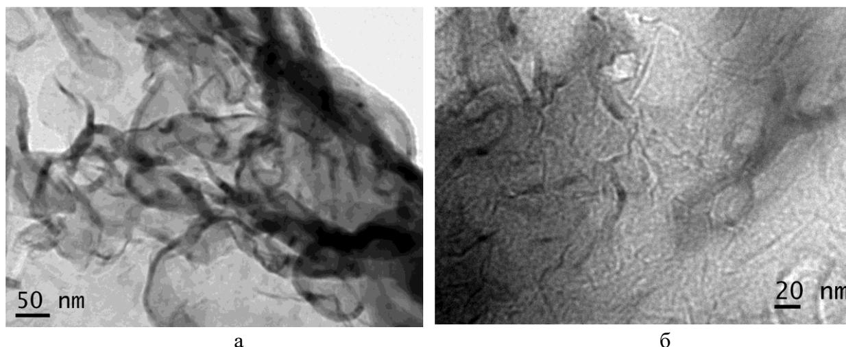
Рисунок 64 - ПЭМ микрофотографии мембран МФ-4СК-УНТ-3% (а) и МФ-4СК-УНТ-SO<sub>3</sub>H-3% (б)
