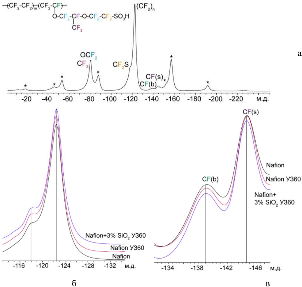
Рисунок 39 -  $^{19}\text{F}$  ЯМР спектр мембраны Nafion, полученной отливкой из раствора полимера (а) и фрагменты  $^{19}\text{F}$  ЯМР спектров исследуемых мембран Nafion+ $\text{SiO}_2$ , полученных методом отливки из растворов после предварительной УЗ обработки (б,в)
