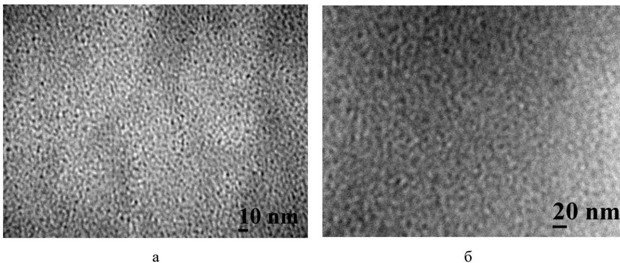
Рисунок 42 - ПЭМ микрофотографии гибридных мембран, полученных методом отливки из раствора полимера в присутствии прекурсора, на основе МФ-4СК с содержанием 1.3 (а) и 4.2 мас.% (б) оксида церия
