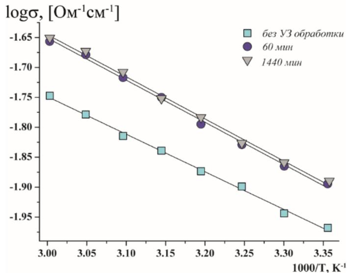
Рисунок 27 - Температурная зависимость ионной проводимости мембран Nafion, полученных из растворов без обработки и после 60 и 1440 минут обработки в УЗ ванне, в  $\text{Na}^+$  форме. Измерения проведены в контакте с водой
