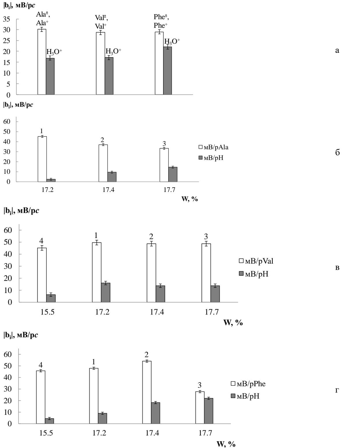
Рисунок 76 - Коэффициенты чувствительности ПД-сенсоров на основе мембраны МФ-4СК, полученной методом отливки (влажносодержание 16.9%) к катионам, цвиттерионам аминокислот и ионам  $H_3O^+$  (а) и зависимость коэффициентов чувствительности ПД-сенсоров к ионам  $Ala^{\pm}, Ala^+$  (б),  $Val^{\pm}, Val^+$  (в),  $Phe^{\pm}, Phe^+$  (г) и  $H_3O^+$  от влажносодержания мембран МФ-4СК, содержащих 0.5% (1), 1.0% (2), 1.5% (3) и 3.0% (4)
