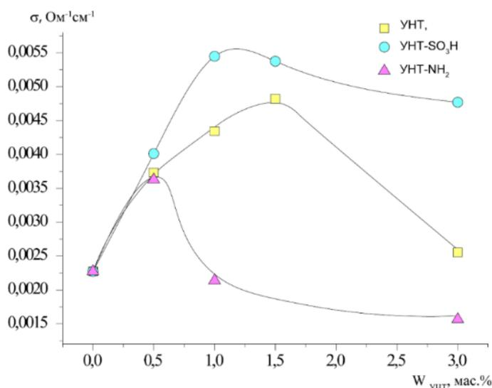
Рисунок 66 - Зависимость протонной проводимости от массовой доли допанта для мембран МФ-4СК, содержащих УНТ и УНТ с функционализированной поверхностью.
