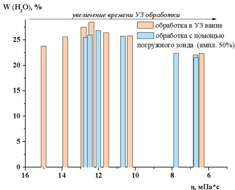
Рисунок 25 - Влагосодержание мембран Nafion в протонной форме в контакте с водой (W, %) в зависимости от вязкости раствора полимера. УЗ обработку растворов проводили с помощью УЗ ванны и погружного зонда с амплитудой 50%
