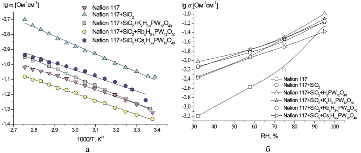
Рисунок 55 – Протонная проводимость гибридных мембран
