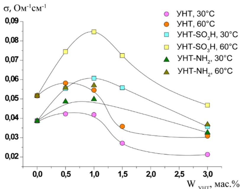
Рисунок 65 - Зависимость протонной проводимости от массовой доли УНТ при 30 и 60°C.
