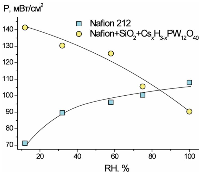
Рисунок 73 - Зависимость максимальной мощности МЭБ на основе мембран Nafion 212 и  $\text{Nafion}+\text{SiO}_2+\text{Cs}_x\text{H}_{3-x}\text{PW}_{12}\text{O}_{40}$  от влажности входящих газов. Измерения проведены при 25°C
