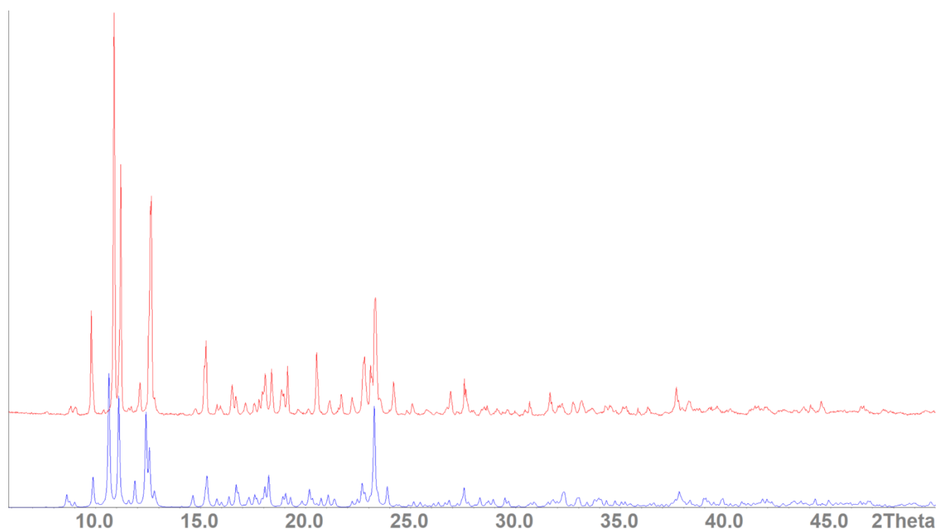
Рис. П7. Теоретическая рентгенограмма 11 (синяя) и рентгенограмма 11 , полученного выдерживанием продукта синтеза при 70 °С в течение 3 часов (красная)
