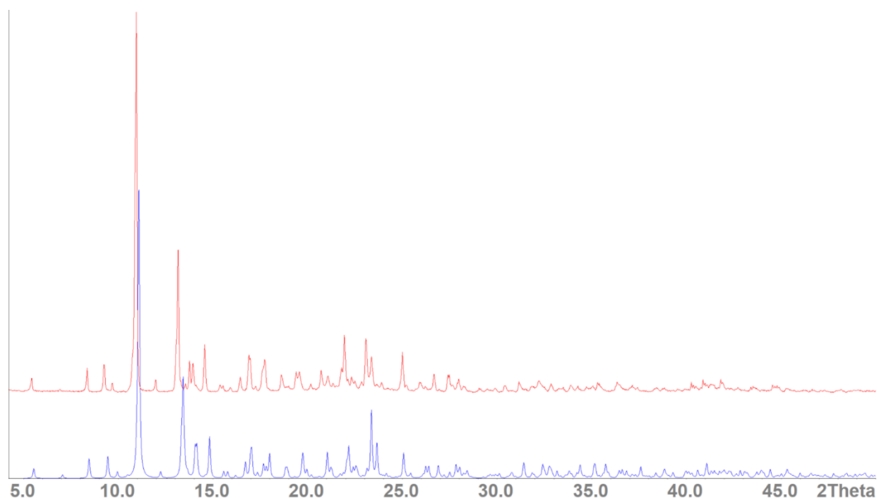
Рис. П5. Теоретическая рентгенограмма 10 (синяя) и рентгенограмма продукта, образовавшегося в синтезе 10 (красная).
