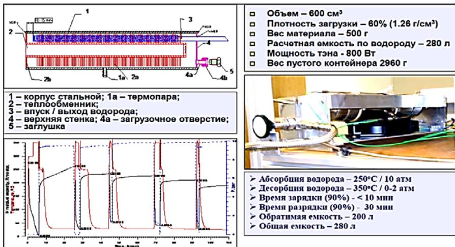
Рисунок 71 – Высокотемпературный аккумулятор водорода на основе сплавов магния.
