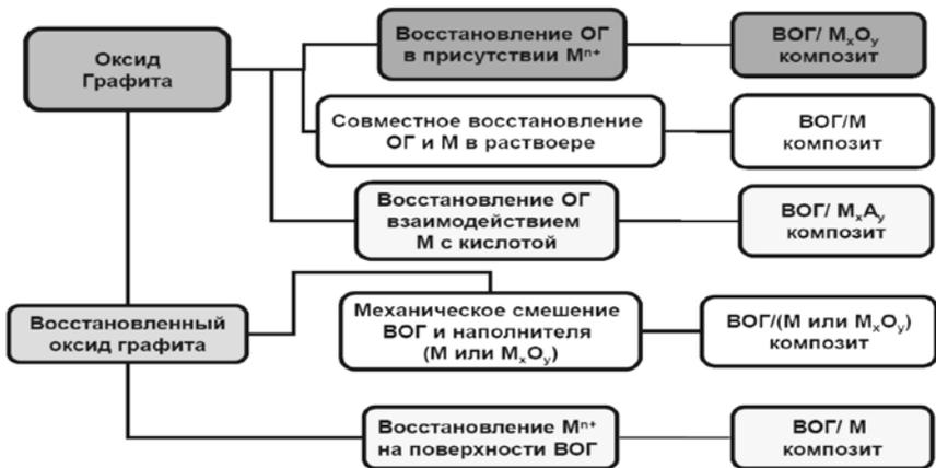
Рисунок 51 – Схемы синтеза металл-графеновых композитов [129–131].
