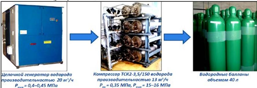
Рисунок 75 – Опытно-экспериментальная линия производства водорода в АО «СКТБЭ» [28, 159–161].
