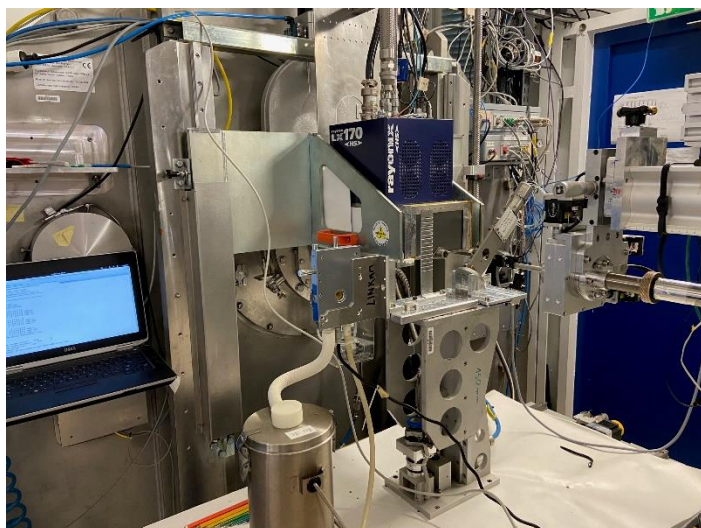
Рисунок 27 - Левая панель : общий вид экспериментальной установки для проведения in situ деформационных экспериментов на станции ID02 (ESRF), совмещенных с регистрацией двумерных картин мало- и широкоугольного рассеяния. Правая панель : отдельное изображение самодельной установки для одноосного симметричного растяжения образцов
