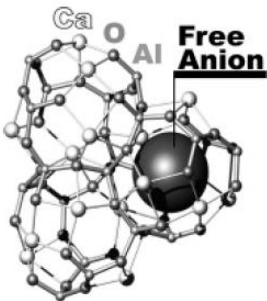
**Рисунок 2.5** – Каркас  $\text{C}_{12}\text{A}_7$  и находящийся внутри анион [29]
