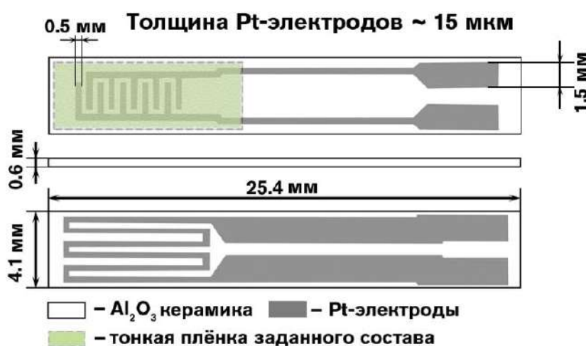
Рис. 11. Схема специализированного датчика для изучения сенсорных свойств покрытий ZnO
