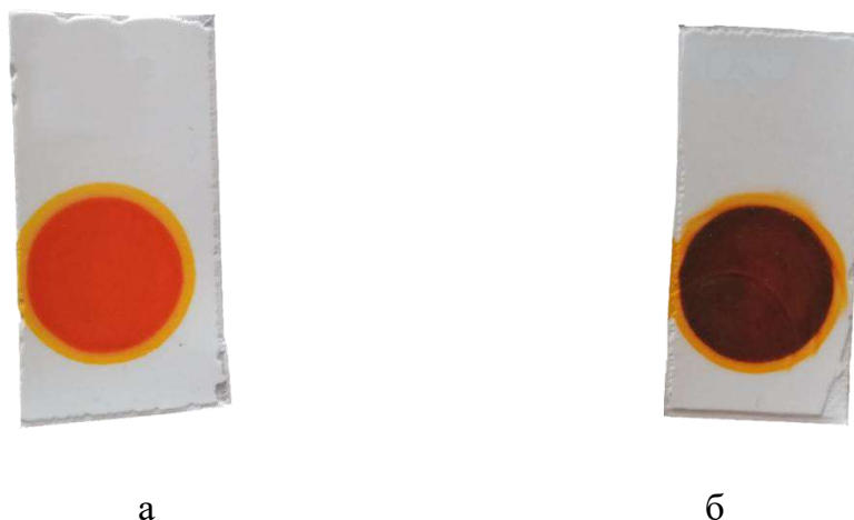
Рисунок 71. Капли нанесенного раствора 34 в ДМФА на подложку из \text{SiO}_2 без (а) и с (б) использованием антисольвента.
