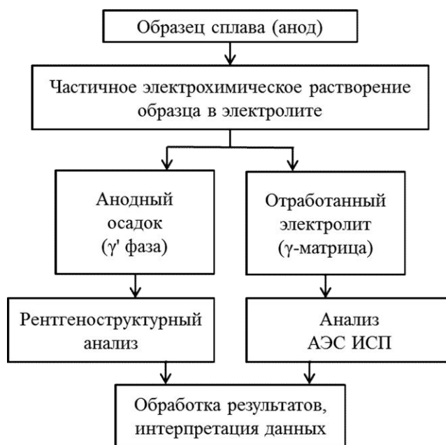
Рисунок 25 - Схема исследования количественного фазового состава ЖНС с применением электролитической экстракции и АЭС ИСП для анализа электролитов.
