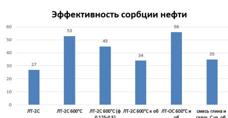
**Рис. 1 –** сравнение эффективности сорбции исходных, активированных, модифицированных образцов глин
