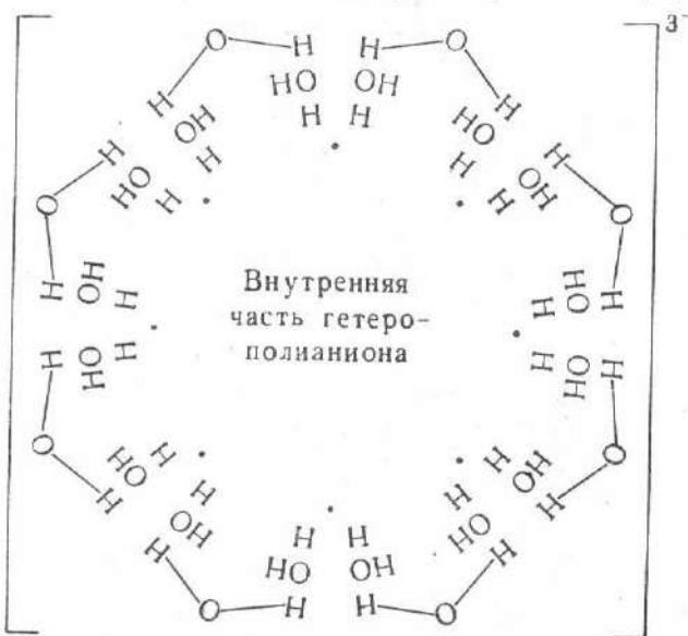
Фиг. 13. Порядок расположения «водяных мостиков» в гидратированном гетерополианионе ( $24 \text{ H}_2\text{O}$ ). Предельный гидрат с содержанием 32 молекул  $\text{H}_2\text{O}$  получается присоединением к 8 внешним кислородам еще 8  $\text{H}_2\text{O}$ , образующих следующий слой
