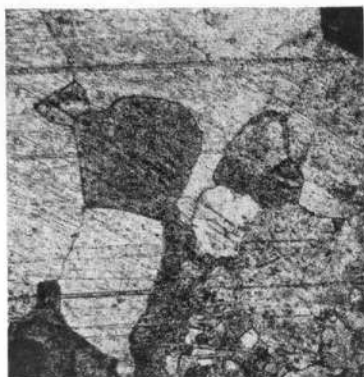
Фиг. 4. 6,69% вес.% Re; 93,31 вес.% Pt; \times 200
