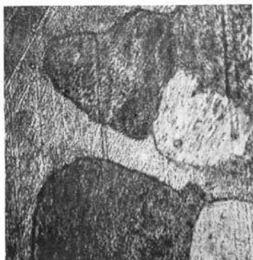
Фиг. 2. 0,12 вес.% Re; 99,88 вес.% Pt; \times 200
