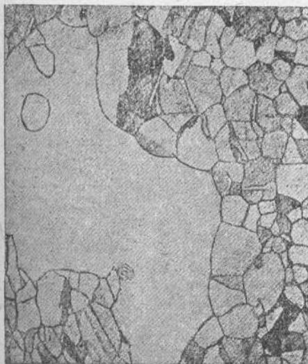
Фиг. 11. Микроструктура торгового палладия № 1, отожженного при 1100° в течение 5 мин.
