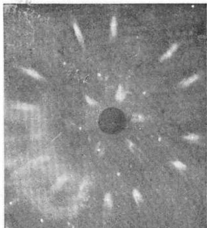
8. Ляуэ-грамма „кристалла“ осмистого иридия; расстояние между пленкой и кристаллом 5 см. Близ центрального пучка видны пятна отражений 2-го порядка.
